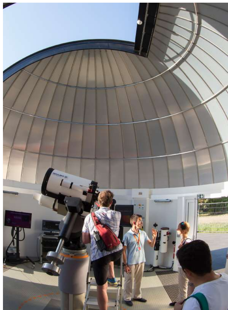
Sous ses 7m50 de diamètre, la coupole abrite un télescope de 40 centimètres et une lunette dédiée à l'observation du Soleil.
